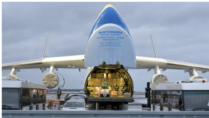
Im Bug befand sich eine ausklappbare Laderampe
