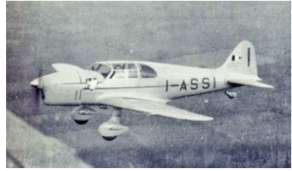
Abb. 2 | Das einmotorige Zweiplätzer-Sportflugzeug Ambrosini S.1001 Grifo I-ASSI war mit einem 120 PS starken Alfa Romeo-Motor ausgerüstet. Bildquelle: www.alfasport.net
