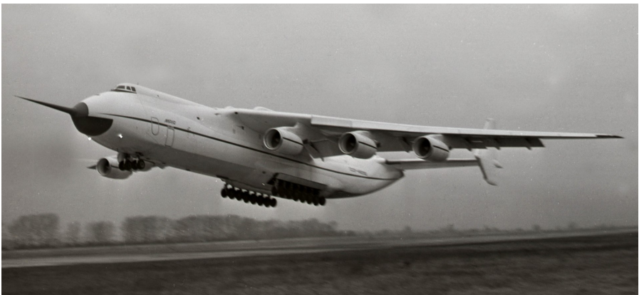
Start zum ersten Testflug. Vorne an der Nase war ein spitziger Stachel angebracht, welcher Sensoren für verschiedene Instrumente und Aufzeichnungsgeräte enthielt.
