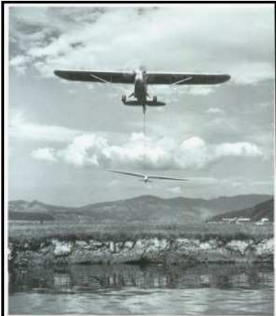
1951 gesellte sich zur Fluggruppe Oberer Zürichsee die Segelfluggruppe „Möve“. Im Bild das Hochziehen eines Segelflugzeuges durch ein Motorflugzeug. Bei genügender Höhe klinkte der Segelflugpilot das Seil aus. Der Motorflugzeugpilot klinkte das Seil vor dem Landeanflug über dem Flugplatz aus und landete erst nach dem zweiten Landeanflug, nachdem das Seil von der Piste entfernt wurde.
