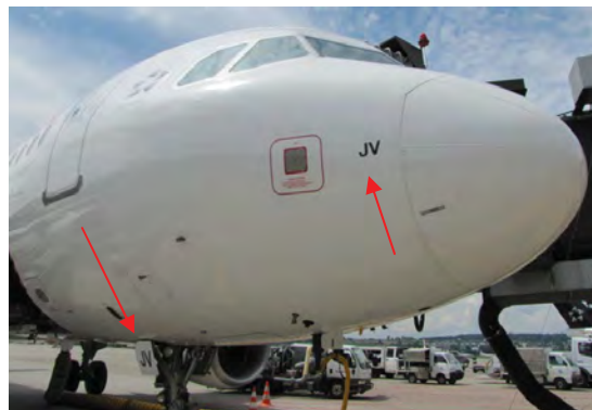
HB-IJV, eine A320 der Swiss. Die letzten beiden Buchstaben sind vorne links und rechts bei der Flugzeugnase sowie unten bei der Bugrad-Klappe angebracht.
