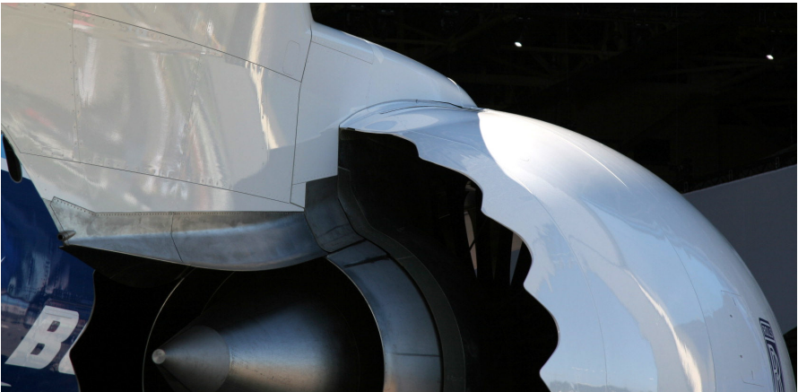
Gut sichtbar die zickzackförmige Hinterkante beim Luftauslass der Fanluft.
