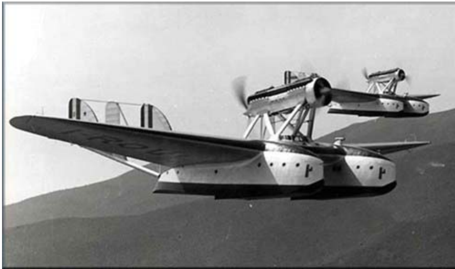
Savoia Marchetti S.55 A ,ausgerüstet mit Fiat A12-Motoren mit einer Leistung von 300 PS. Unter den Motoren ist die Pilotenkanzel angeordnet.
